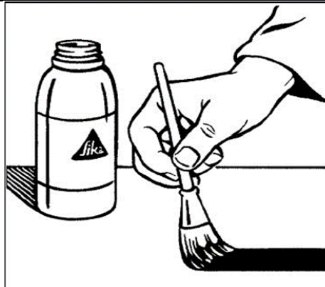
Čiščenje fasadnih plošč s čistilcem SikaCleaner® 205
