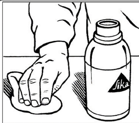
Čiščenje fasadnih plošč s čistilcem SikaCleaner® 205
